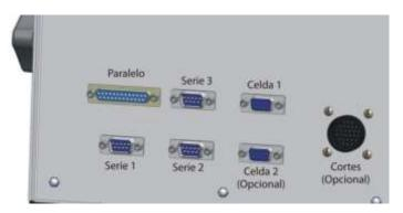
Los conectores son: Celda de carga 1, Celda de carga 2 (opcional), puertos series 1,2 y 3, puerto paralelo y puerto de cortes (opcional)
